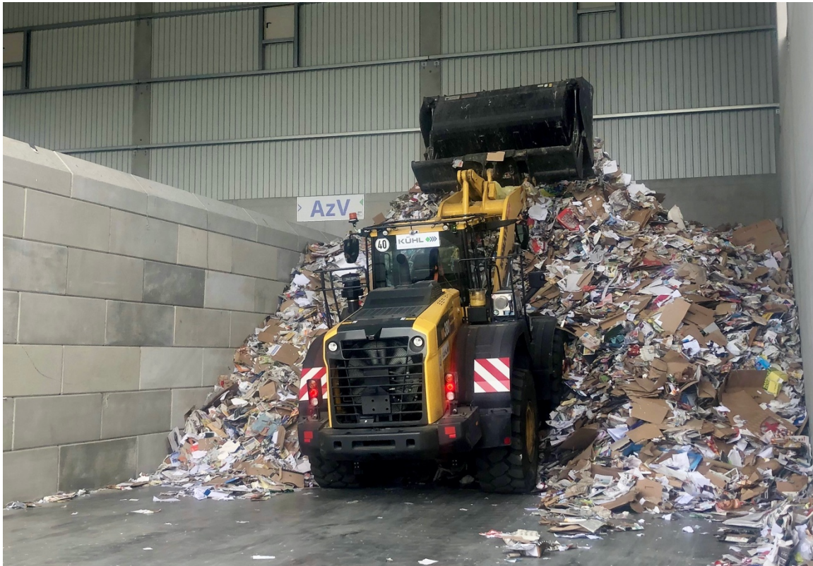
Bild 2: Der Komatsu WA380-8 ist zum Aufladen und Umladen von Recyclingmaterial bis zu neun Stunden täglich im Einsatz.
