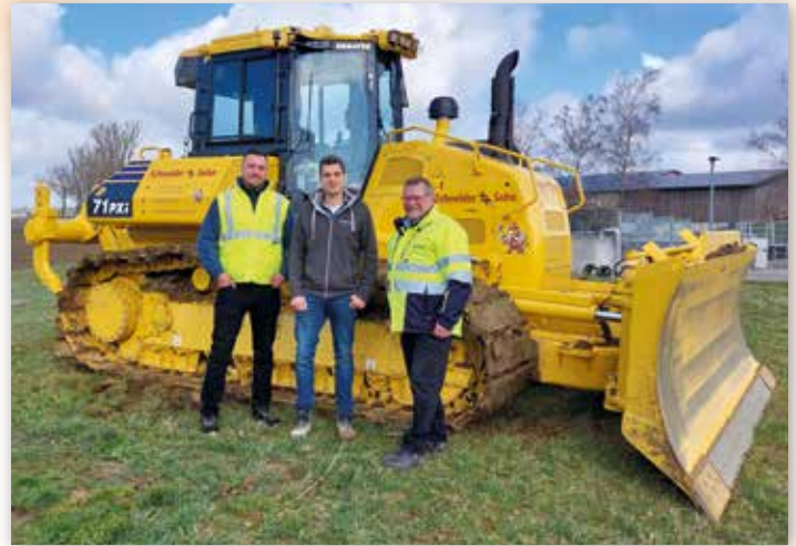
Der D71PXi-24 mit seiner markant abgeschrägten Motorhaube – optimale Sicht auf Schild und Laufwerk bei voller Konzentration auf präzises Planieren. Im Bild (von links): Manuel Sommerkorn – Gebietsverkaufsleiter Kuhn, Christian Schneider – Eigentümer, Jochen Reißwenger – Verkaufsleiter Kuhn Baden-Württemberg
