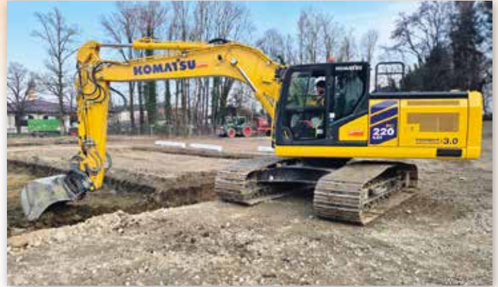
Präzises Arbeiten mit dem Komatsu PC220LCi-12: er ist als erster Bagger seiner Klasse serienmäßig mit iMC 3.0 ausgestattet.
