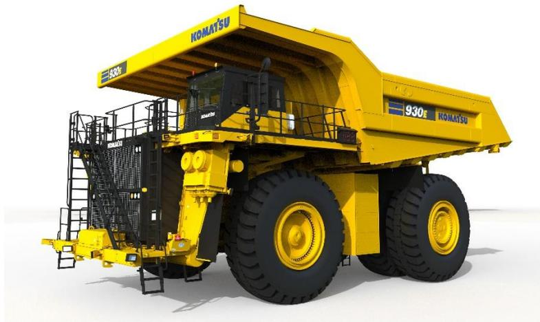
*Der Komatsu 930E Muldenkipper, der zukünftig von Hydrotec-Brennstoffzellen angetrieben wird.*
