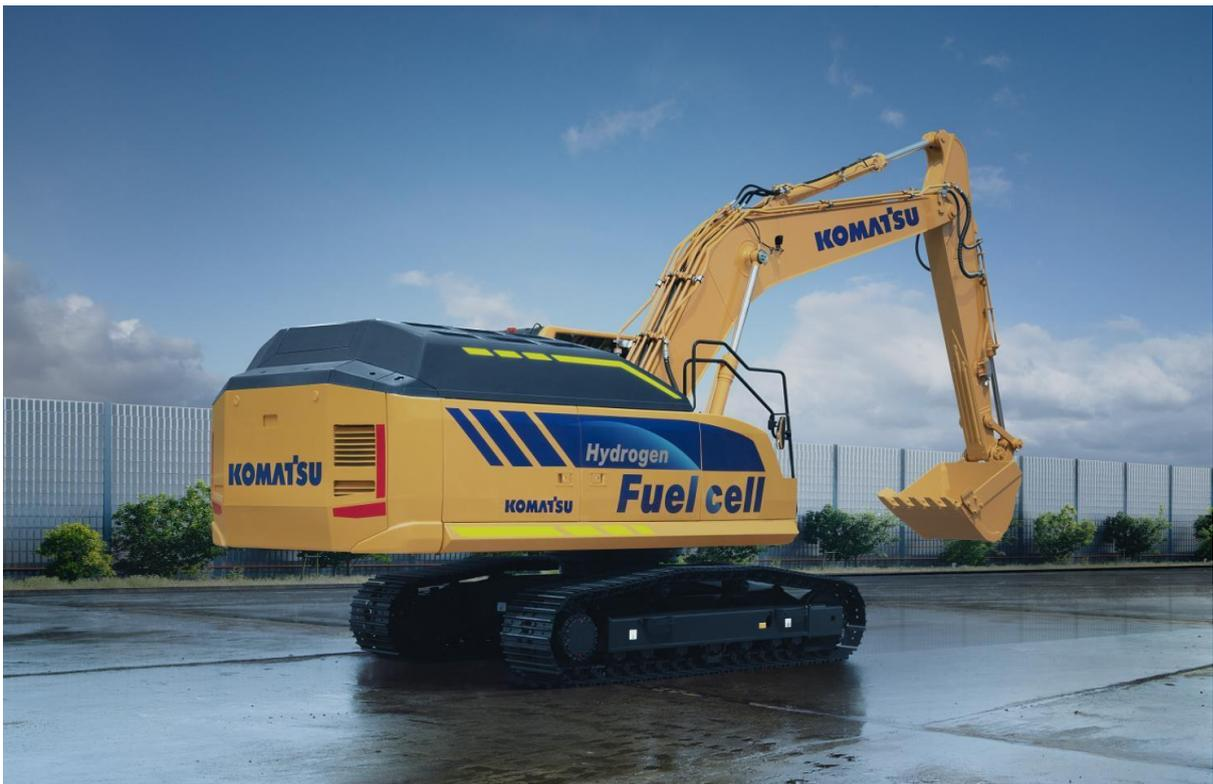
— Konzeptmaschine eines mittelgroßen Hydraulikbaggers mit Wasserstoff-Brennstoffzelle
