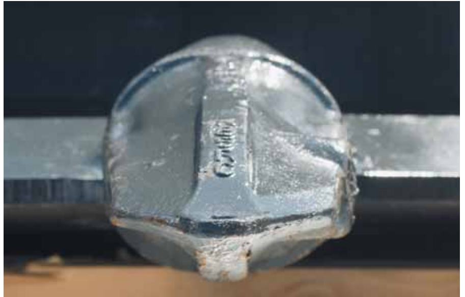
Gestreckte, elliptische Zahnform
