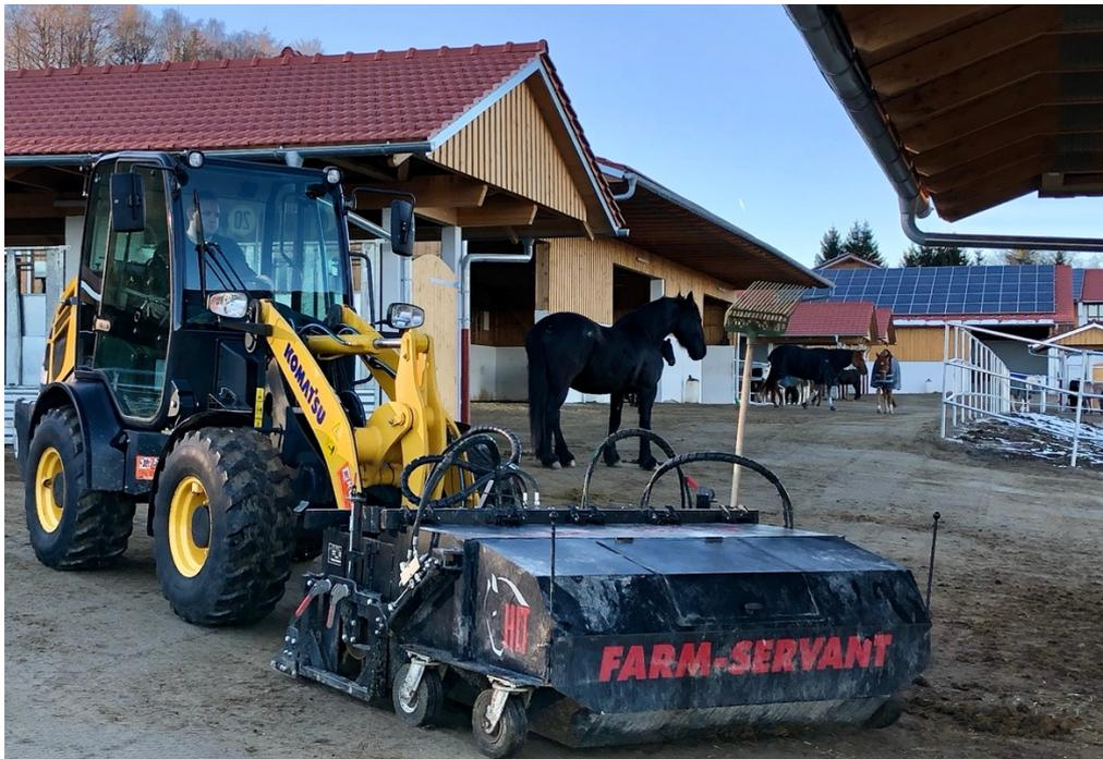
Bild 1: Der neue Komatsu WA70 wird auf dem Schneiderhof mit zahlreichen Anbauteilen verwendet: Hier mit dem Abmstgerät, mit dem die Bodenmatten gesäubert werden.
