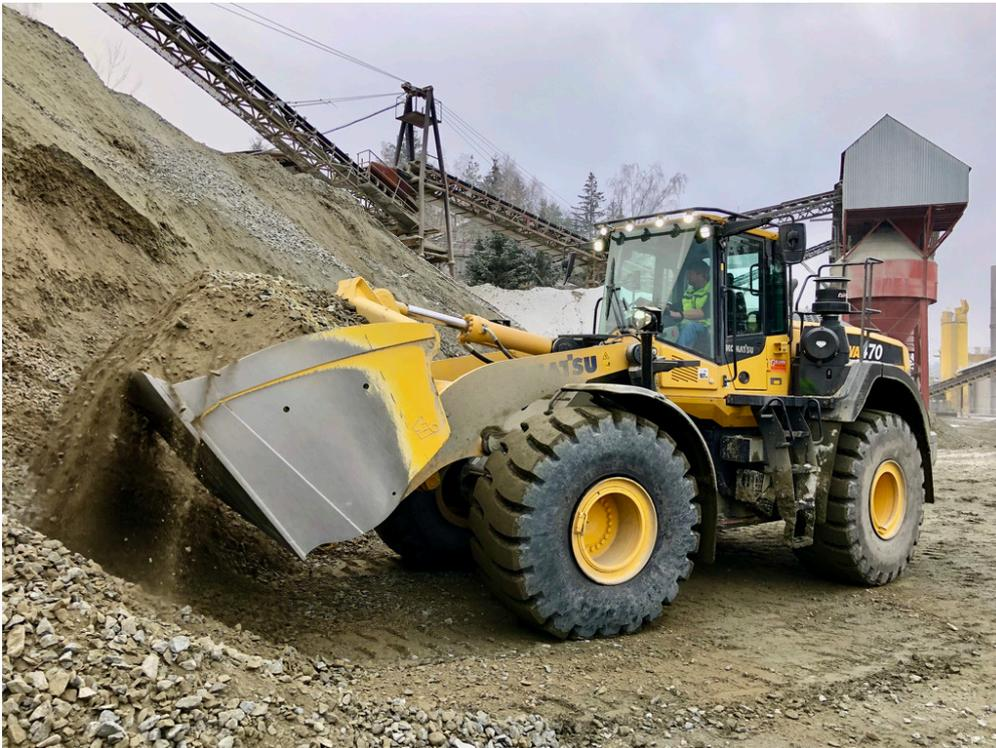
Bild 1: Im Thiele Granit Werk Schönberg arbeitet der neue Komatsu Radlader WA470-8. Er wird in Schönberg für die Rückverladung von verschiedenen Granit-Schüttgüter wie Schotter und Splitte eingesetzt. Mit einem Schaufelvolumen von 4,7 Kubikmeter erreicht er maximale Produktivität.
