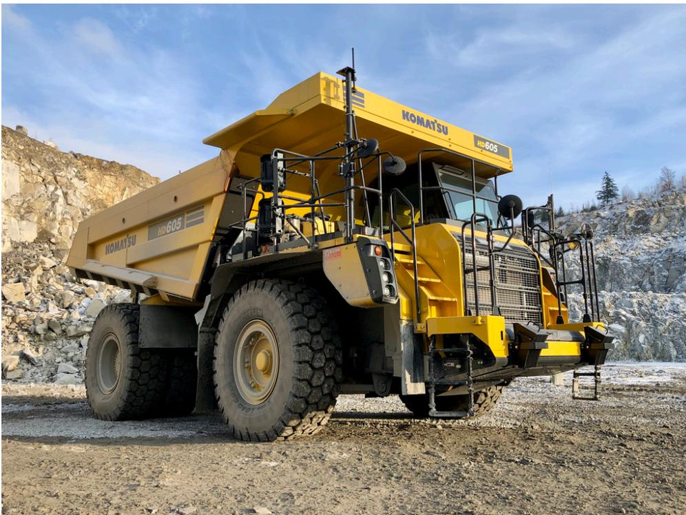
Bild 2: Für das Thiele Werk Hötzensberg wurde der neue Muldenkipper HD605-8 angeschafft. Er zeichnet sich durch einen besonders kraftstoffsparenden Antriebsstrang und den kleinsten Wenderadius in dieser Klasse aus.
