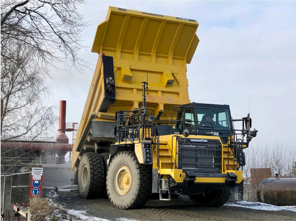
Bild 3: Der Komatsu HD605-8 wird in Hötzelberg für den Transport des gesprengten Materials aus dem Steinbruch zum Vorbrecher eingesetzt.
