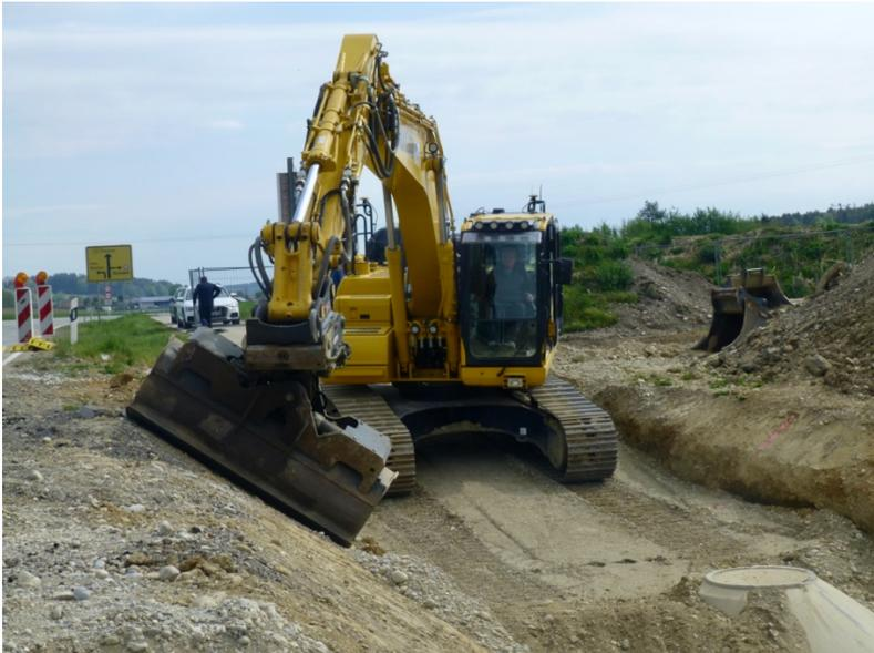
Bild 1: Der neue Komatsu Bagger PC 210LCi-11 der Josef Hogger Tiefbau e. K. ist werksseitig mit der Technologie der intelligenten Maschinensteuerung ausgestattet.
