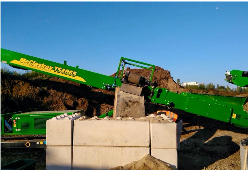
Die nachgeschalteten Haldenbänder vom Typ McCloskey TS 4065, die in ihrer Abwurfhöhe stufenlos, hydraulisch bis zu neun Meter einstellbar sind, wurden mit Überbandmagneten komplettiert, um den Reinheitsgrad des Materials zu steigern.
