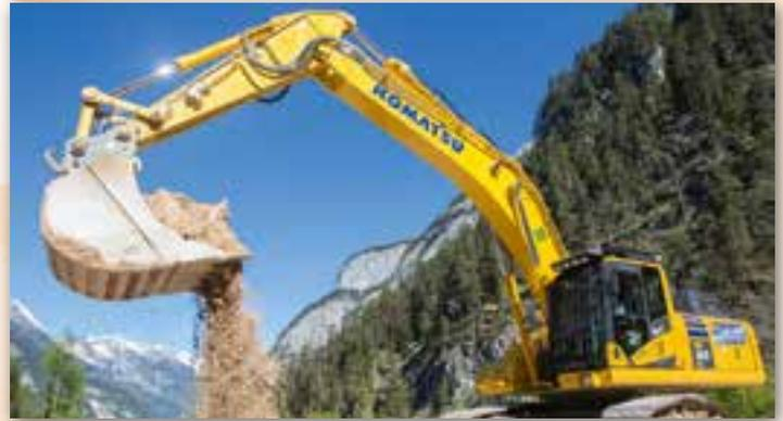
Der Hybridbagger HB365-LC3 wird zum allergrößten Teil für die Rohstoffgewinnung im SSK-Kieswerk in Saalfelden eingesetzt.
