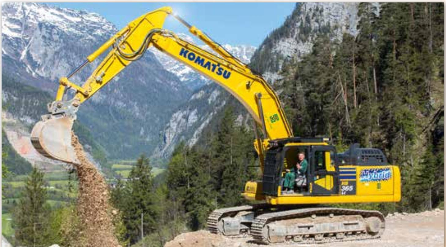
Das Gerät arbeitet mit einem elektrischen Hybridssystem. Der Hydraulikbagger speichert Energie beim Abbremsen der Schwenkbewegung des Oberwagens in einem Superkondensator neben dem Ausleger.
