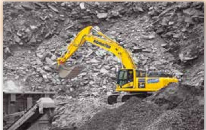
Komatsu Bagger HB365LC-3 mit Hybridantrieb, 36 t Betriebsgewicht
